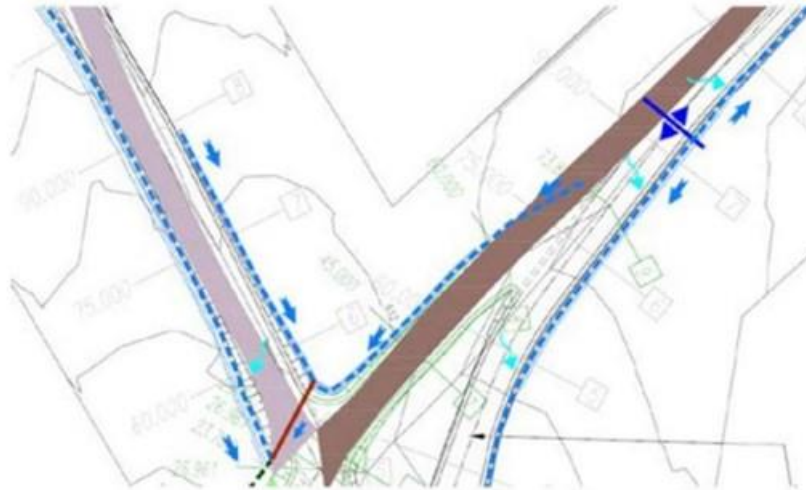
Figura 73 - Exemplo de planta que mostra as obras de drenagem da principal via de acesso à região do SED
