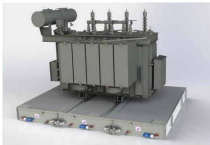
Figura 76 - Exemplo de contenção de volume limitado
